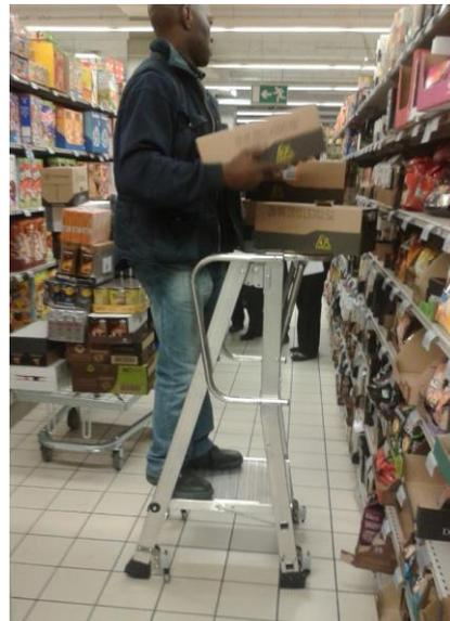
Un soporte técnico útil: la herramienta combina una plataforma para productos y un soporte de mesa para paquetes, ambos de altura variable. Esto facilita la colocación de los productos en los estantes al reducir el esfuerzo requerido de los empleados. Es especialmente útil para productos colocados en los estantes superiores. La herramienta también permite que los empleados puedan sentarse mientras colocan productos en los estantes inferiores. En general, esto reduce el riesgo de TME.
